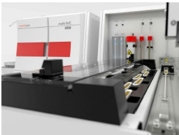
Il modulo HT 1300 possiede un sistema indipendente di disidratazione e de-alogenazione del flusso gassoso prodotto in combustione ed inviato al detector FR-NDIR del modulo base, nonché un sistema di regolazione puntuale dei flussi di gas applicabili.
