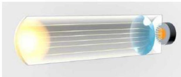
Il detector di Analytik Jena, a differenza dei comuni detector IR, non utilizza la riflessione da parte delle pareti del detector per ottenere la propagazione della radiazione nel tubo. Il detector FR NDIR è infatti composto da una cella in quarzo, nella quale la radiazione viene focalizzata sul micro-detector; questa tecnologia assicura la massima efficienza energetica,
