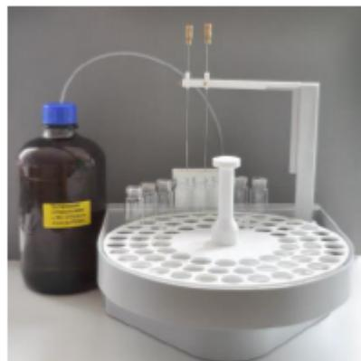
Per garantire la massima accuratezza, l'autocampionatore è dotato di stazione external-rinse ove effettuare il lavaggio automatizzato degli aghi di prelievo campione. Questa funzione risulta molto importante quando si effettua l'analisi di acque di scarico contenenti notevoli quantità di solidi sospesi che possono contribuire a fenomeni di carry-over analitico.
