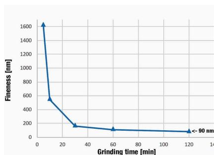
Macinazione fino al range nanometrico di 25 g di titanio diossido in un barattolo da 125 ml di ossido di zirconio con 275 g di sfere da 0,1 mm e 30 ml di soluzione di NaPO<sub>4</sub> all'1%. Dopo 120 minuti di macinazione si è raggiunta una granulometria di 90 nm.
