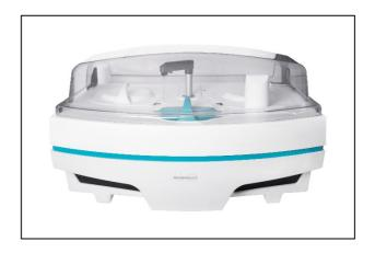
Smartchem 450 offre un'efficienza incomparabile grazie alla sua capacità di carico (100 campioni, 72 reagenti) e un'elevata produttività fino a 300 test/ora. Lettori di codici a barre, reagenti pronti all'uso, connettività, tutto è stato progettato per ottimizzare le prestazioni. La grande autonomia di Smartchem 450 consente di risparmiare molte ore di lavoro.
