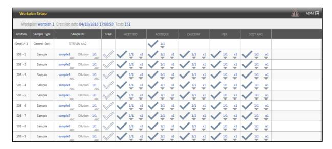
È possibile raggruppare i metodi in un profilo per gestire un'analisi di più parametri. Pertanto, se si desidera ad esempio misurare sia i nitrati che i nitriti su un singolo campione, è possibile creare un profilo "Nitrati-nitriti" e aggiungere ad esso sia il metodo nitrati che i nitriti. Il software consente anche per ciascun campione di
