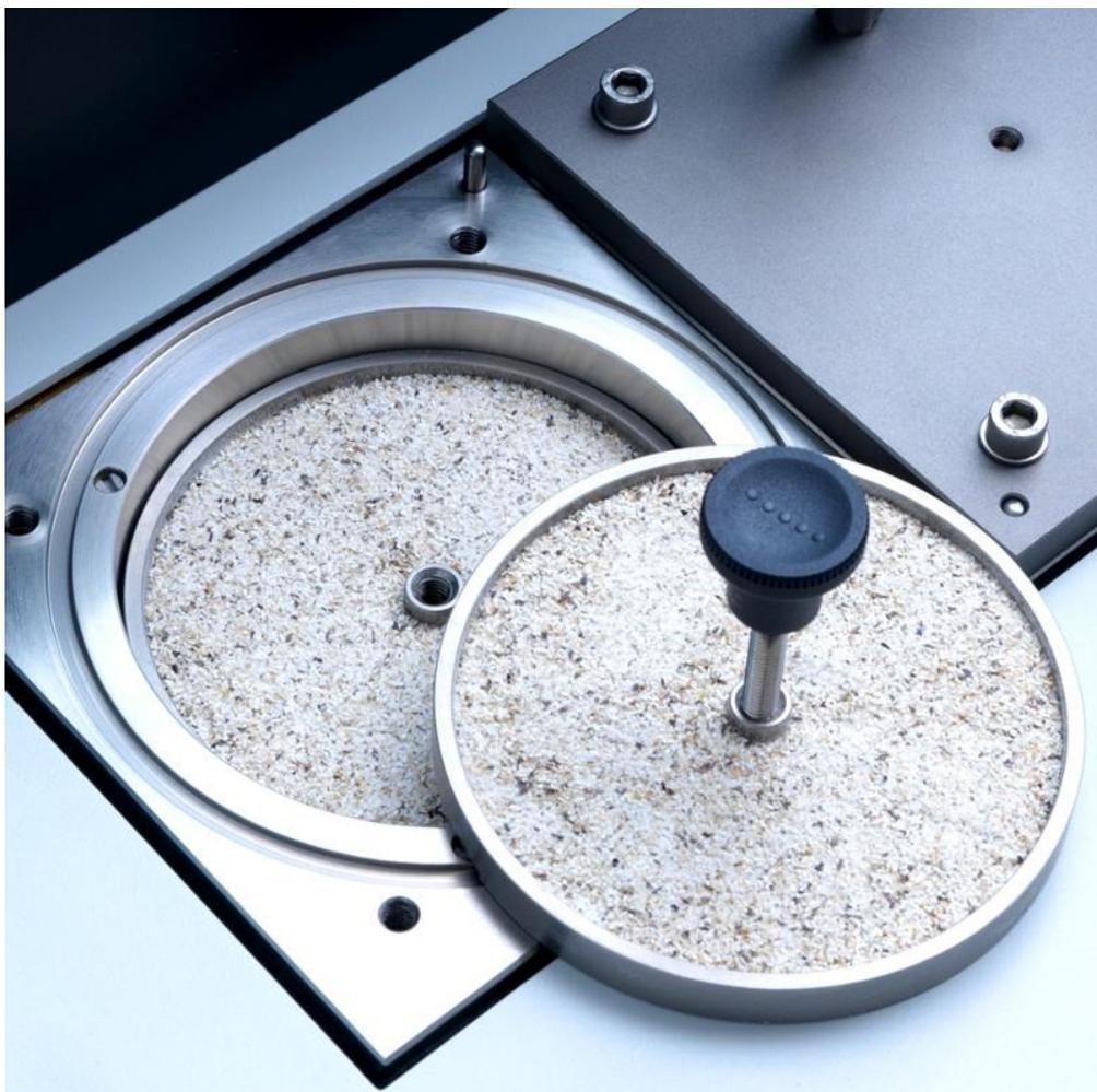
Il reattore OXITEST sottopone il campione ad un ambiente ad elevato stress ossidativo per valutare, in un breve lasso di tempo, la resistenza all'ossidazione dei grassi:
