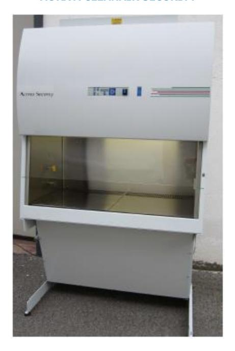
La cappa (funzionamento in aspirazione frontale quale cappa chimica) è appositamente realizzata per la manipolazione di supporti e materiali contenenti amianto, sia massivi che sotto forma di fibre, assicura la protezione globale sia dell'operatore che dell'ambiente non solo nelle fasi di attività lavorative ma anche durante le fasi di manutenzione in cui è previsto il cambio del filtro assoluto.
